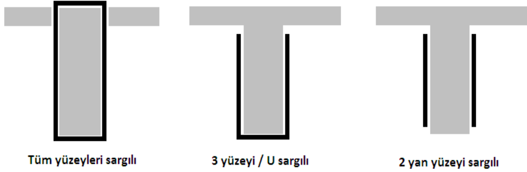
Şekil 5.1 ACI 440 Yönetmeliği'nde yer alan CFRP uygulama tipleri
